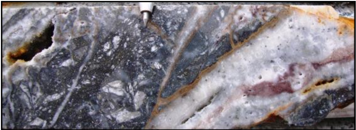
Figura. 15. Ejemplo de una fotografía especial DDH. LB216 131,10 m. HYBX, clasto soportada, sil + py + alunita + Cus.
