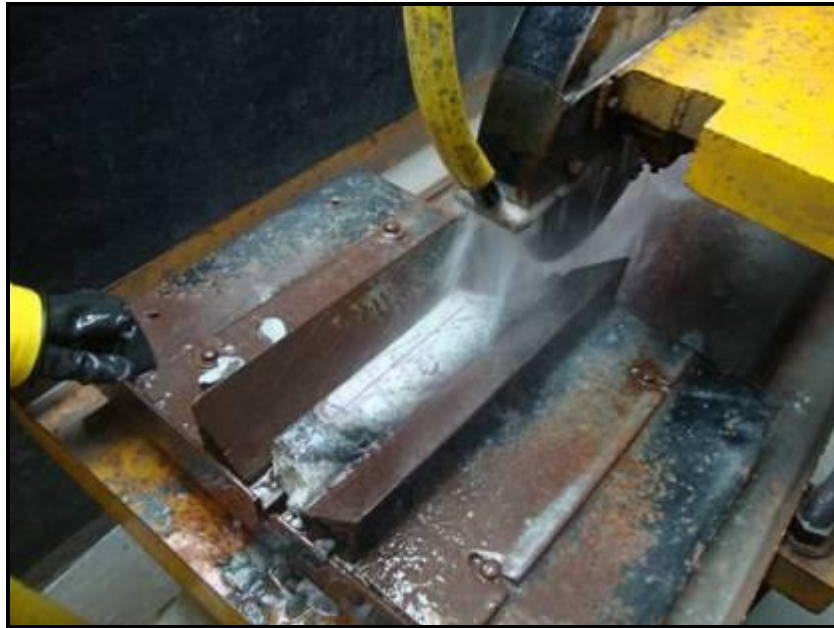
Figura. 17. Procedimiento de corte de núcleo. En la muestra, una marca de color muestra el lugar correcto donde se debe cortar (eje estructural).
