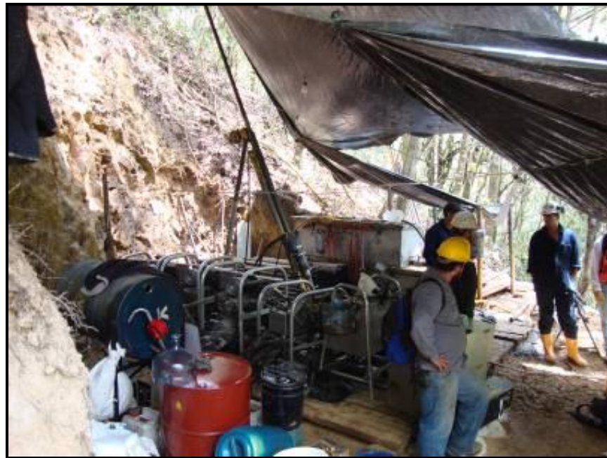
Figura. 7. Maquina y tanques de lodos para perforación.
