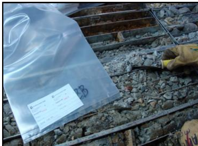
Figura. 20. Toma de muestras de material arcilloso y roca muy fraturada.
