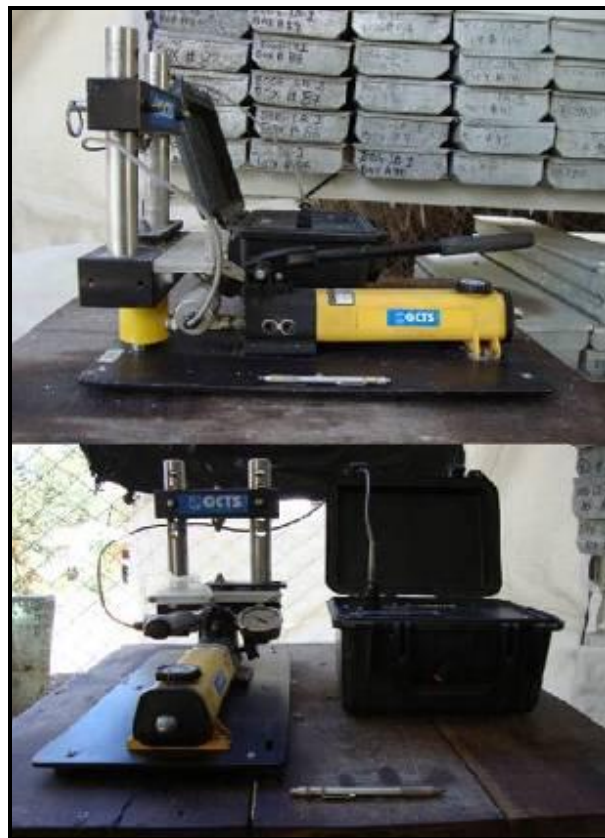
Figura. 10. Equipo para prueba de PLT.
