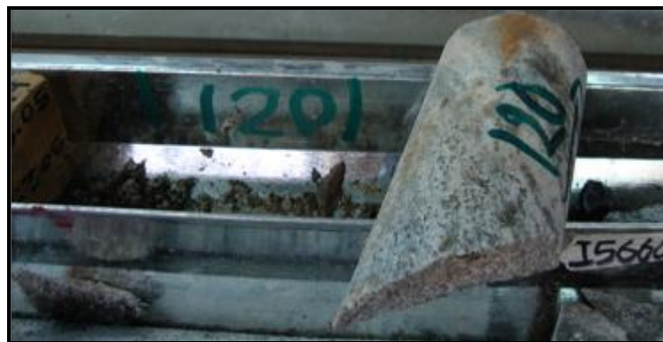
Figura. 26. Ejemplo de una muestra elegida para la medida de gravedad específica.
