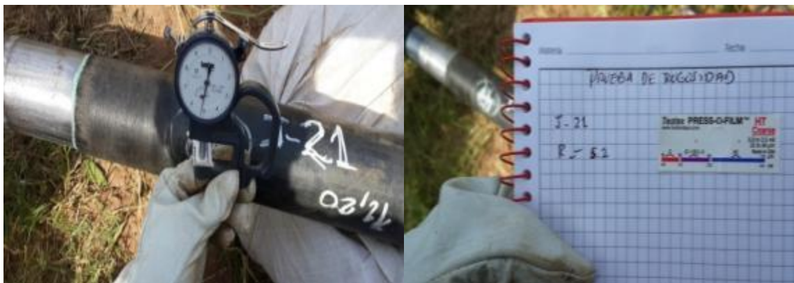
Figura 50. Medición de la cinta impresa y su correspondiente anotación.
