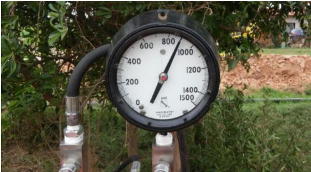
Figura 53. Presión de la prueba hidrostática [900 psi].
