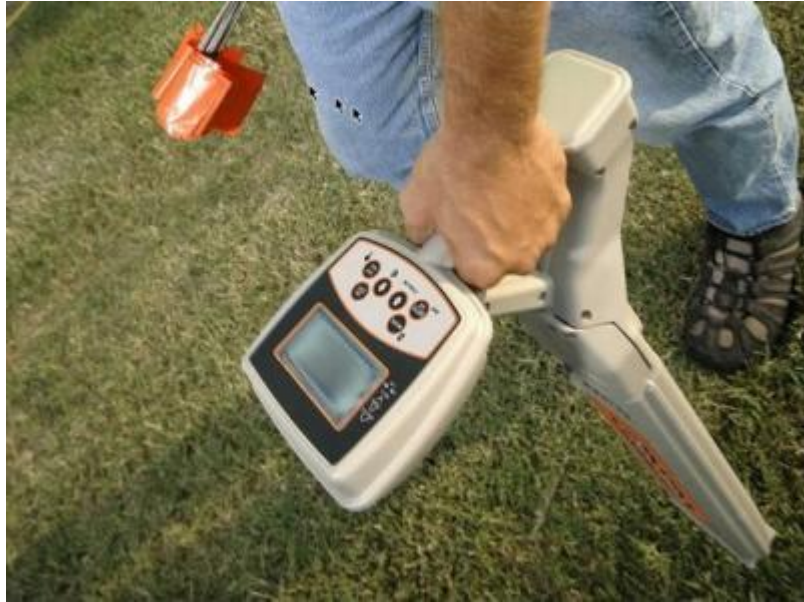
Figura 16. Equipo de localización marca Subsite 750 Tracker.
