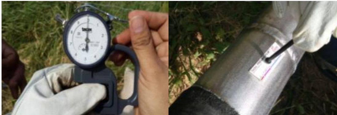
Figura 49. Prueba del medidor e impresión del perfil de superficie en la cinta.
