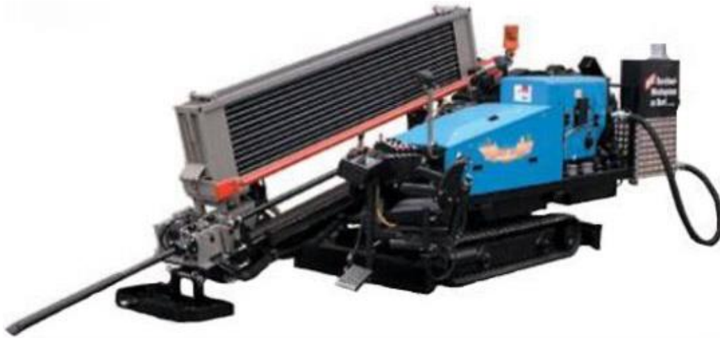
Figura 15. Equipo de perforación horizontal dirigida.
