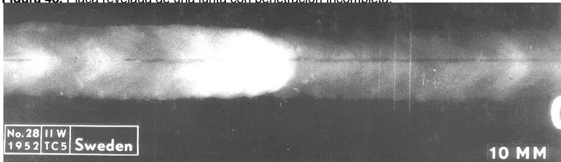
Figura 48. Placa revelada de una junta con penetración incompleta.
