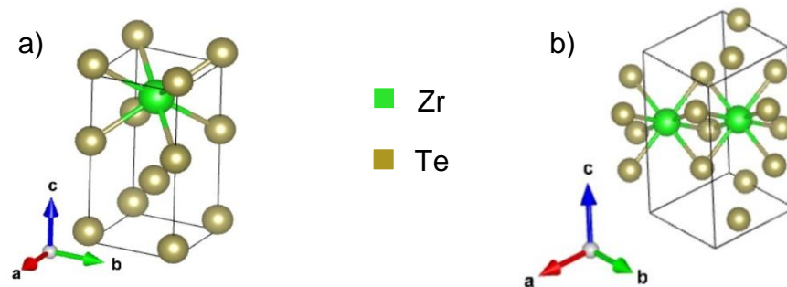
Figura 14. Estructuras cristalinas a 60GPa. a) ID 45 grupo espacial 123, composición 1-3 b) ID 47 grupo espacial 1, composición 2-6.
