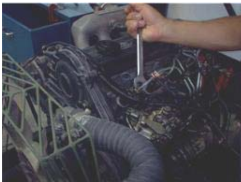
Figura 64. Falla Inducida. Soltura línea de inyección lado inyector
