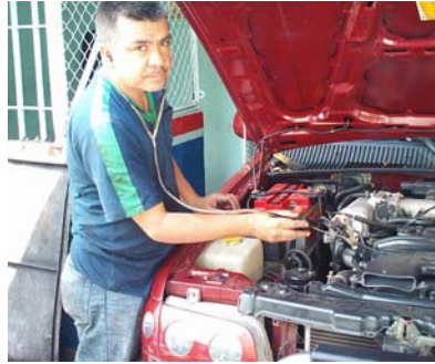
Figura 23. Diagnóstico de fallas por medio de un estetoscopio.
