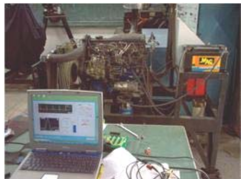
Figura 64. Falla Inducida. Soltura línea de inyección lado inyector
