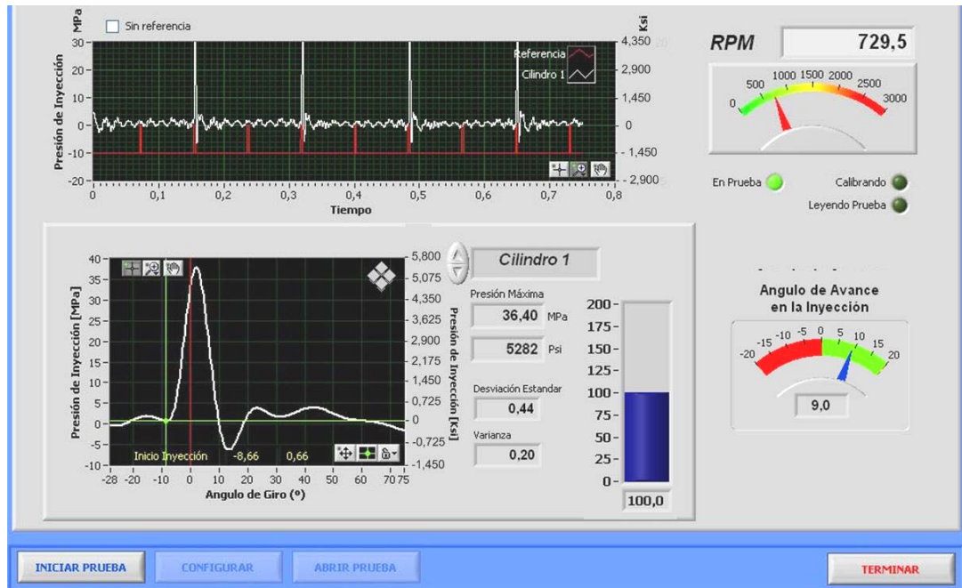
Figura 72. Presión de Inyección en el cilindro 1 de un NPR nuevo.
