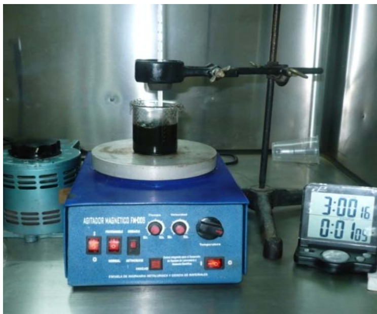
Figura26. Prueba de disolución, plancha de calentamiento con agitación magnética
