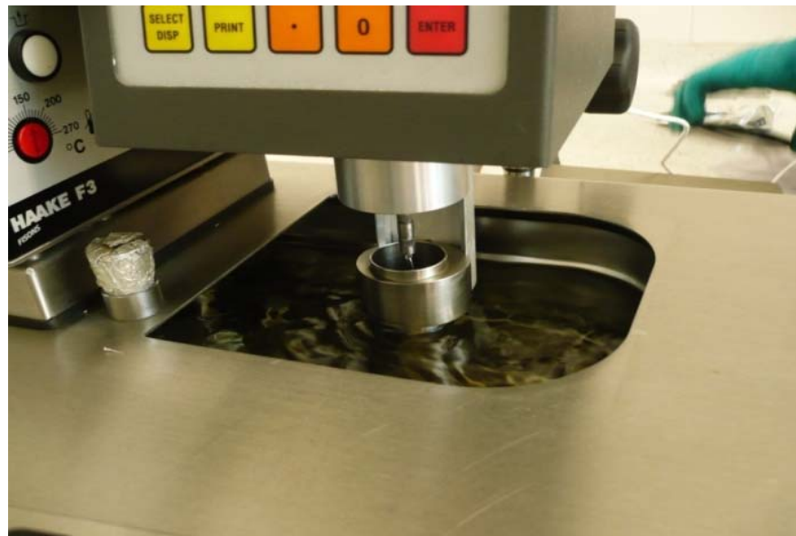
Figura30.Prueba de Viscosímetro Brookfield DV III, sumergido en el baño térmico de aceite.
