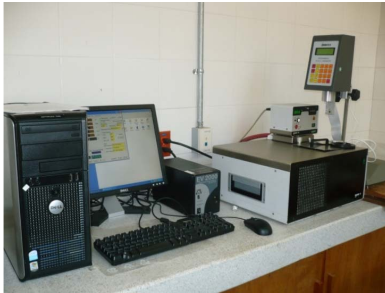
Figura30.Prueba de Viscosímetro Brookfield DV III, sumergido en el baño térmico de aceite.
