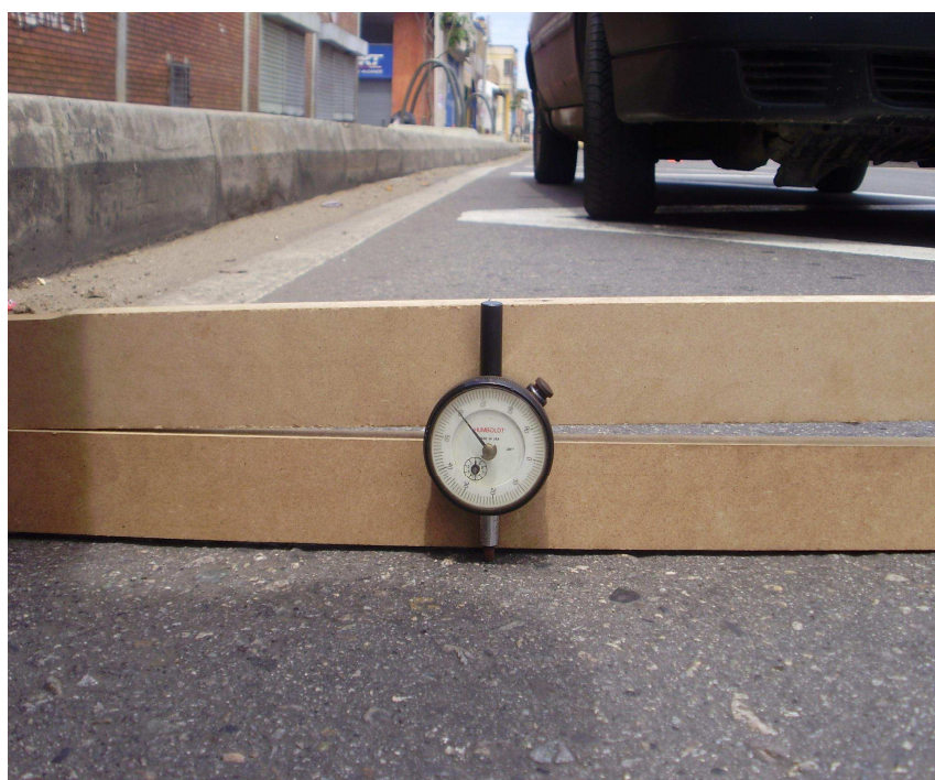
Figura 3. Toma de medidas a lo largo de las zonas de parada
