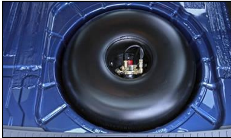
Figura 8. Diseño del depósito de GLP tipo tóricos.
