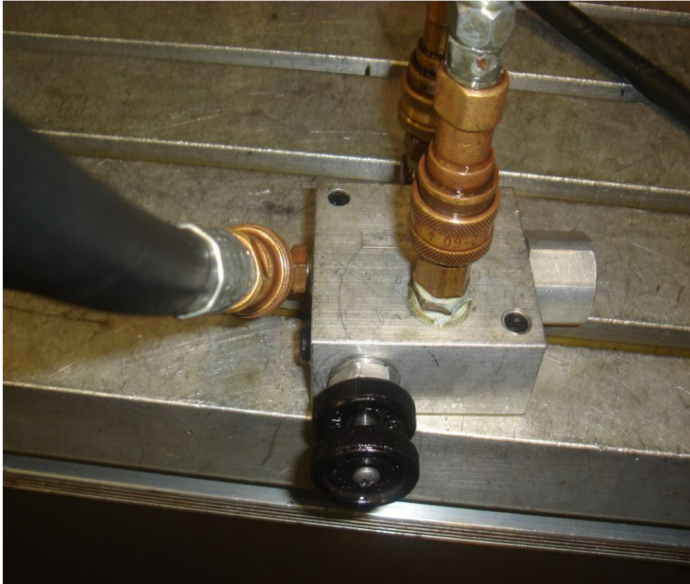
Figura 65. Montaje válvula reguladora de caudal compensada en paralelo
