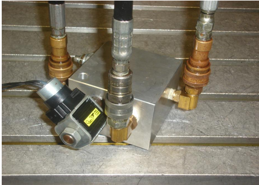
Figura 70. Montaje válvula reguladora de caudal compensada en paralelo con válvula de seguridad venteable
