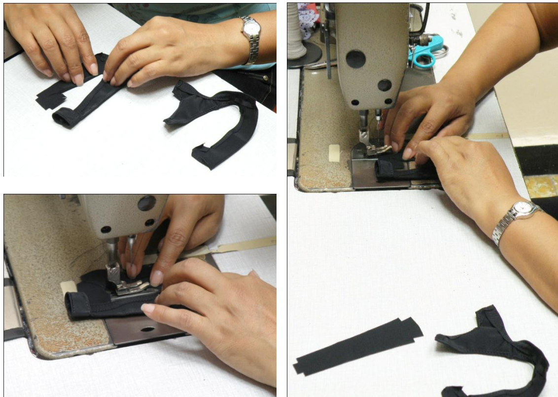
Figura 84. Embonado, armado y costura del elemento de sujeción a la mano
