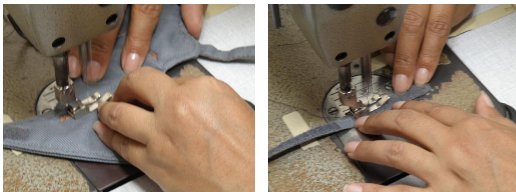
Figura 87. Embonado, armado y costura de la pieza 1
