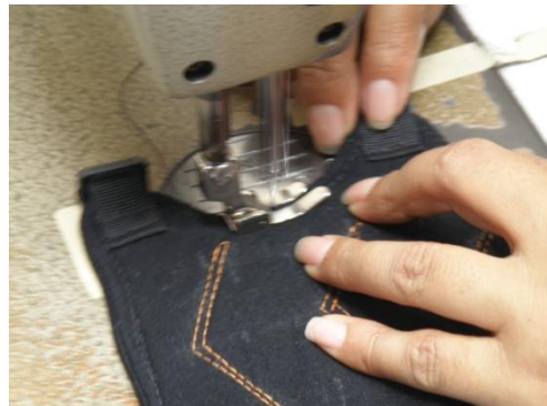
Figura 90. Embonado, armado y costura de la pieza 2
