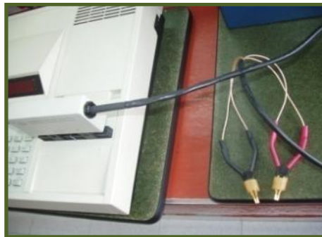
Figura 23. Kelvin Clips del Resistómetro SR715/720.
