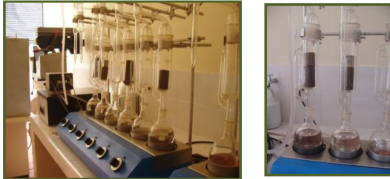
Figura 15. Equipo Dean-Stark Laboratorio Petrofísico UIS-Guatiguará.
