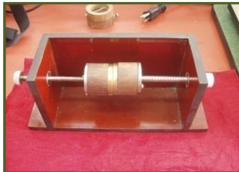
Figura 24. Celda medición de resistividad para Plugs. Fuente: Autores.
