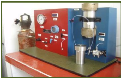
Figura 17. A la izquierda, Vista Frontal Porosímetro CorePet. A la derecha su vista posterior.
