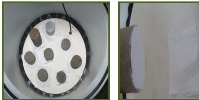
Figura 26. Montaje de las muestras sobre el Plato Poroso.
