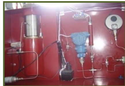
Figura 17. A la izquierda, Vista Frontal Porosímetro CorePet. A la derecha su vista posterior.
