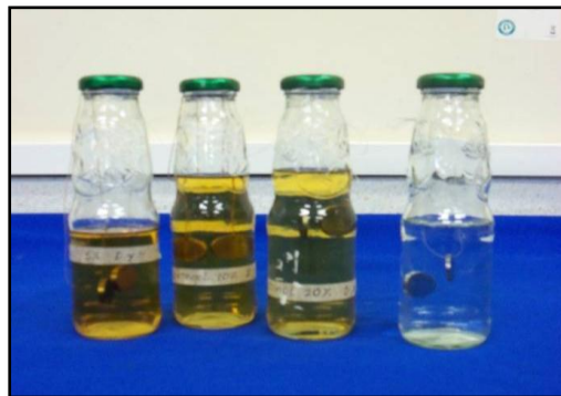
Fotografía 4. Distribución de las probetas en ensayo gravimétrico.
