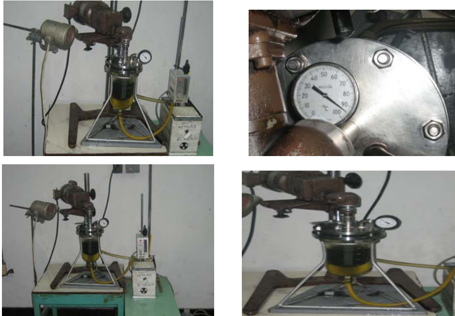
Figura 4. Tratamiento de lixiviación cerrada a 95°C
