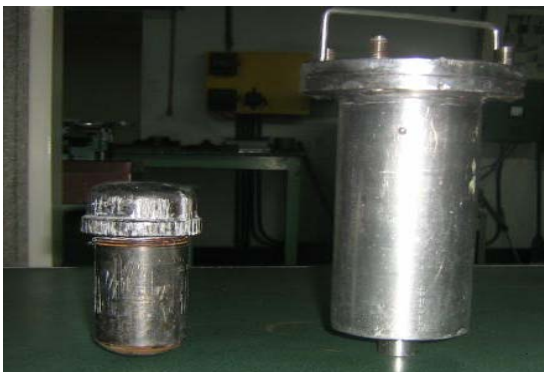
Figura 6. Reactores de acero inoxidable
