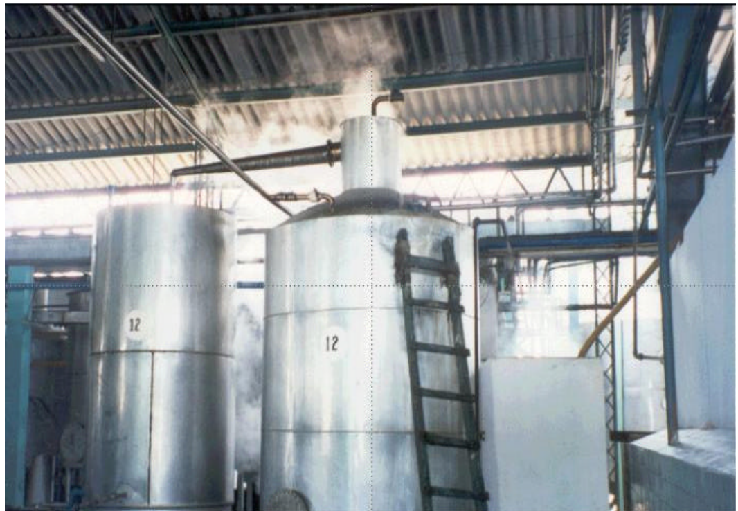
Figura 4. Equipo de arrastre con vapor utilizado a escala industrial. Producción de aceite de lima (Guadalajara, México).
