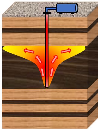
Figura 3. Fenómeno de overriding en una inyección cíclica de vapor. Idea adaptada de Hirasaki G. J. (1989). The Steam-Foam Process . doi:10.2118/19505-PA.
