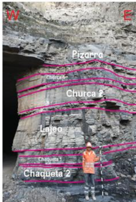
Figura 19. Niveles productores señalizados en la bocamina de Nacuma. La visibilidad de la luz del día permitió a identificar la disposición de las capas. Vista al Norte.
