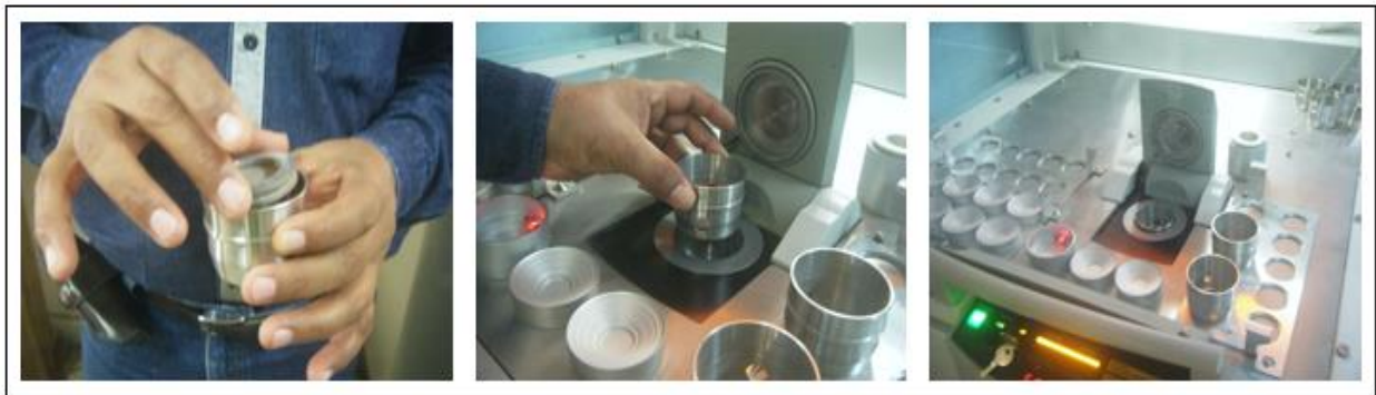
Figura 26. Depósito de las pastillas prensada en el porta-muestra y luego en la cámara de muestras del espectrómetro de fluorescencia de rayos X. Tomado de Cemex, Colombia (2017).
