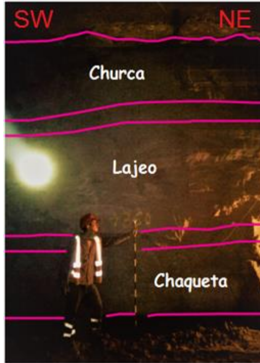
Figura 18. Ilustración de los tres principales niveles de explotación de yeso en el túnel 8 dentro de la mina de la mina La Nacuma. Vista al Noroeste.
