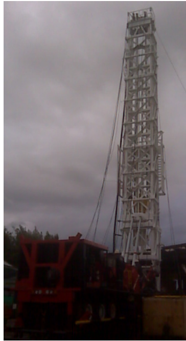
Figura 22. Mástil de un equipo de workover
