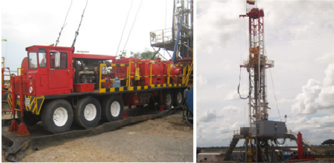
Figura 5. Equipo convencional de workover
