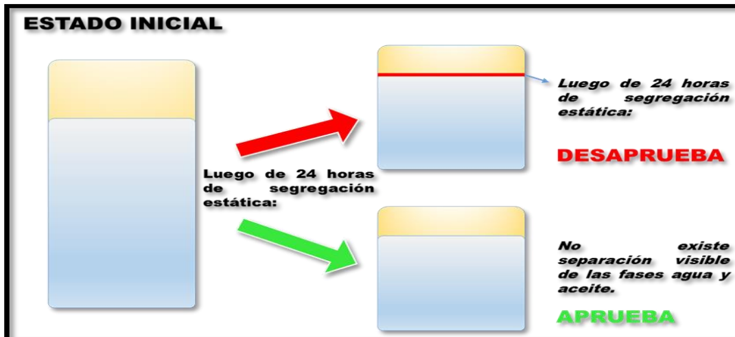
Figura 11. Ilustración de la prueba de contenido de nata de aceite en el agua.
