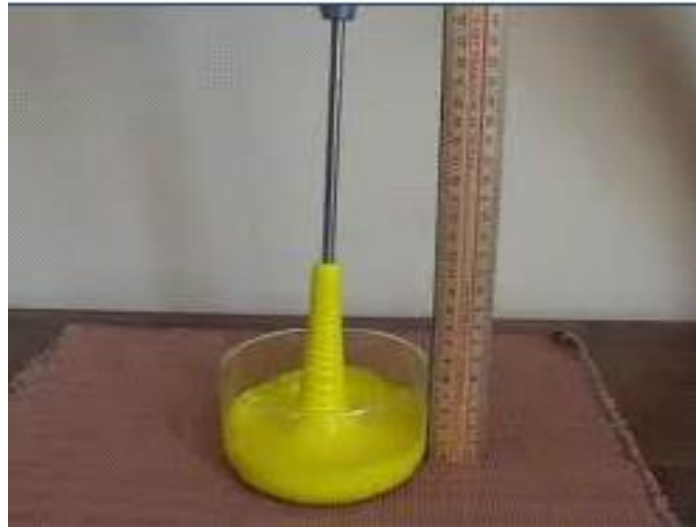
Figura 12. Ilustración del efecto Weissenberg.
