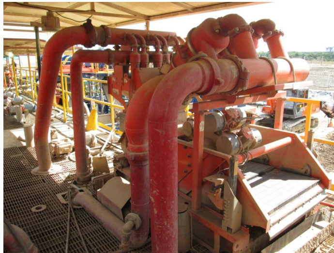
Figura 10: Limpiador de lodo ( Mud Cleaner )
