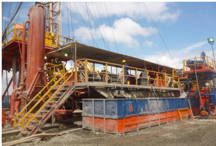
Figura 35: Manejo de rípios. Pozo ANH-BVTURA 1 ST-P
