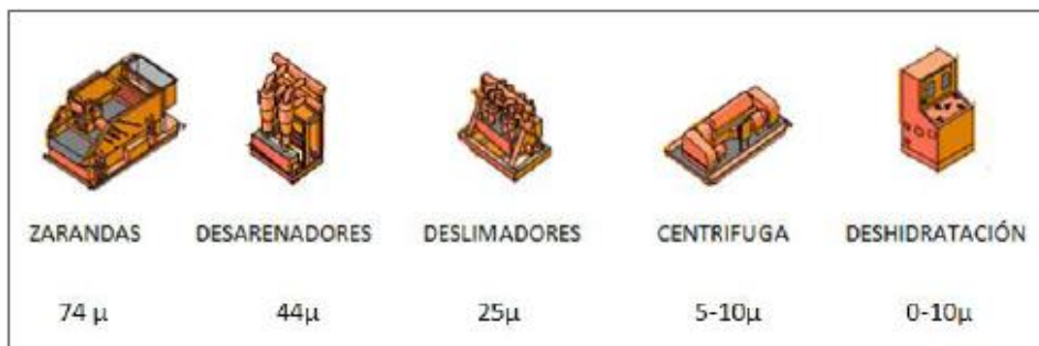
Figura 5: Puntos de corte en equipos de control de sólidos
