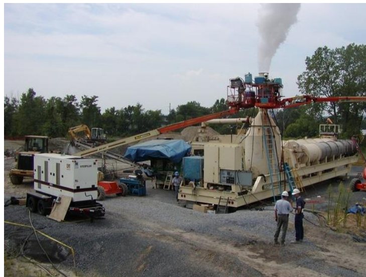
Figura 21: Unidad de Desorción térmica
