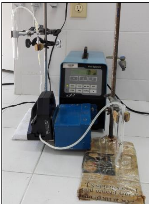
Figura 9. Montaje empleado en el proceso de extracción de los iones metálicos
