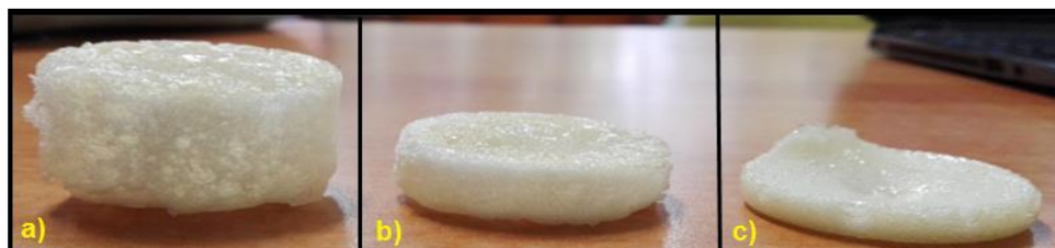
Figura 7. Espumas de PU sintetizadas en relación a) 1:1.9, (b) 1:1.6 y (c) 1:1.3
