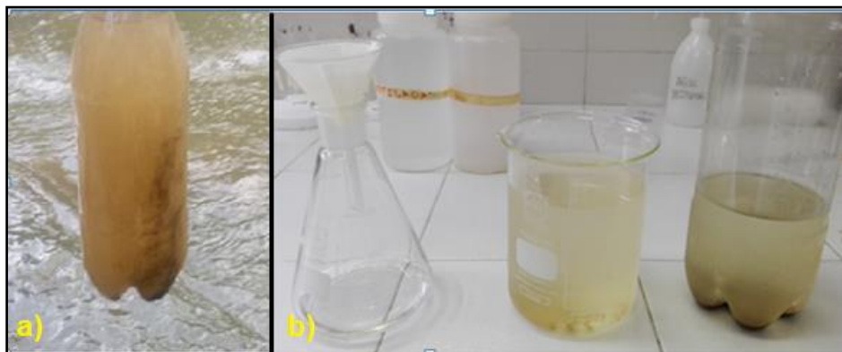
Figura 11. (a) Toma de la muestra real en el río Vetás y (b) proceso de filtración en el laboratorio
