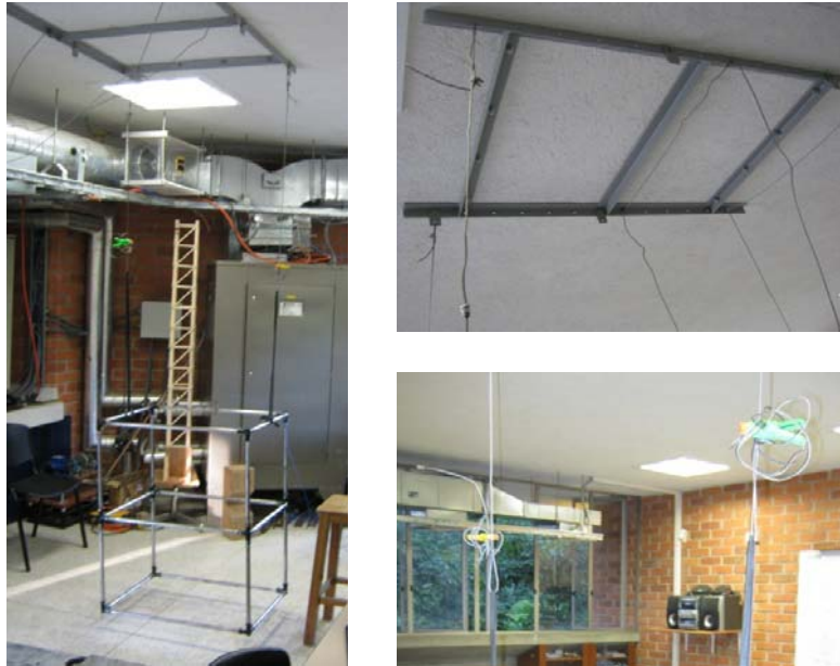
Figura 11. Soporte de la estructura por bandas elásticas
