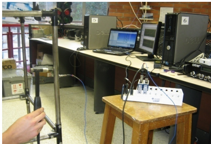
Figura 15. Montaje del ensayo de impacto. Sistema de sujeción del acelerómetro empleando la extensión magnética.
