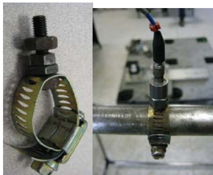
Figura 12. Abrazadera para fijar los acelerómetros PCB 352C34 y PCB 352C68
