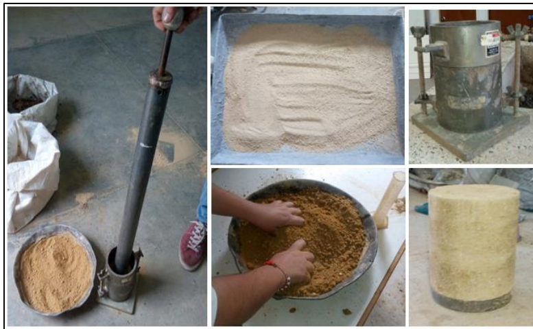
Figura 5. Ensayo de Proctor Modificado.
