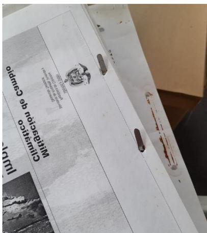
Nota. Se detalla la afectación a causa de la oxidación de los ganchos de metal.
