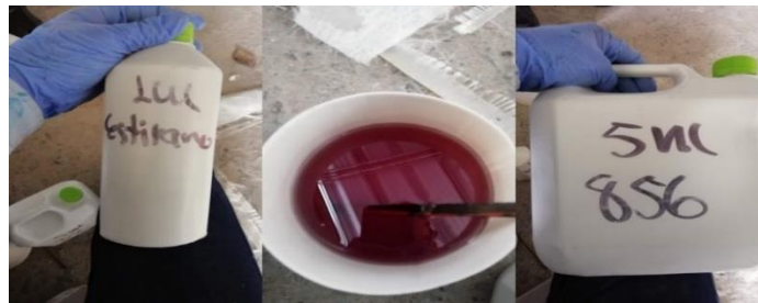
Figura 7. Preparación de Resina Poliéster Critalan 856 necesaria para el formado de los PRFV
