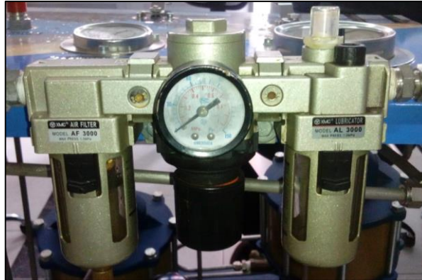
Figura 23. Unidad de mantenimiento FRL
