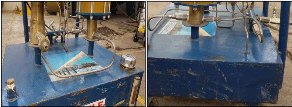
Figura 24. Tanque de almacenamiento de fluidos para alimentación y despresurización del sistema
