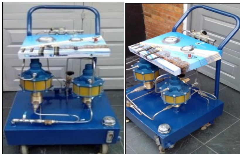
Figura 19. Bomba hidráulica de desplazamiento positivo con accionamiento neumático
