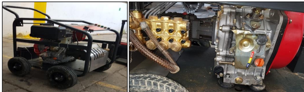
Figura 31. Bomba de desplazamiento positivo diésel
