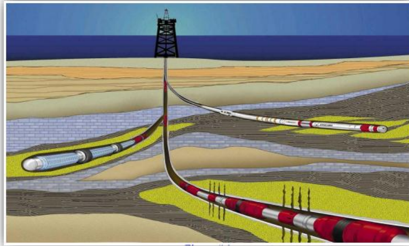
Figura 6. Pozo multilateral drenando varias zonas
