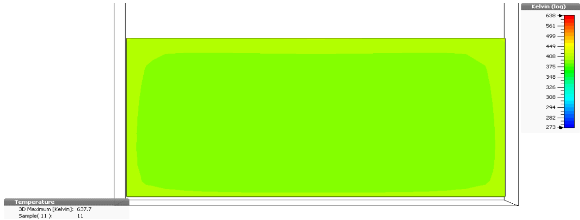
Figura 16. Perfil de temperatura posterior de los absorbentes electromagnéticos.
