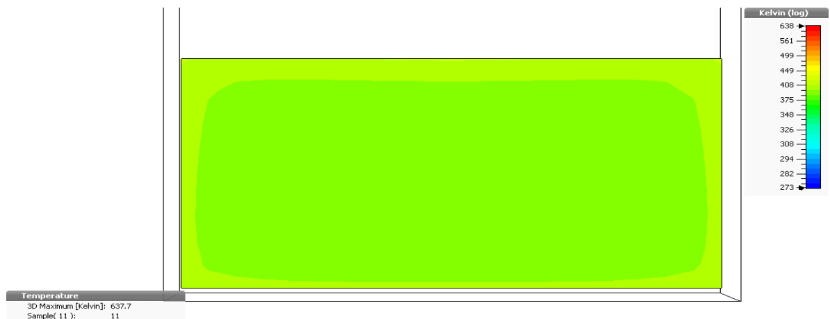
Figura 13. Perfil posterior de temperatura de la placa de cuarzo.
