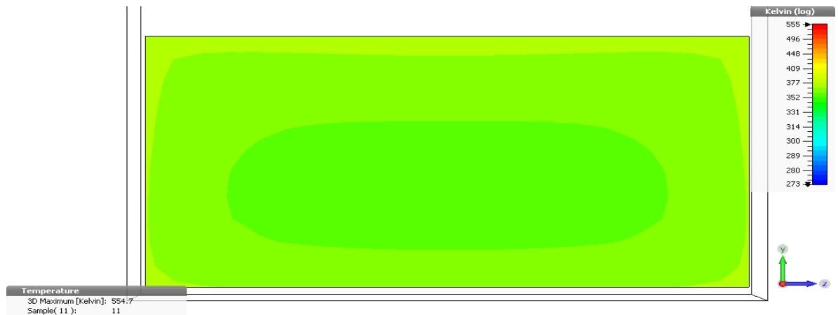
Figura 27. Perfil posterior de temperatura en la placa de cuarzo.
