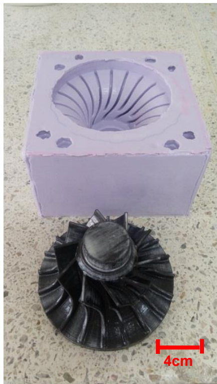
Figura 4. Molde en silicona y modelo impreso 3D.
