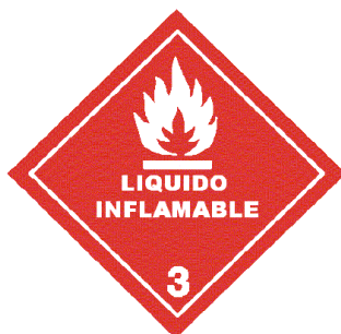
Figura 53. Señalización de líquidos inflamables.
