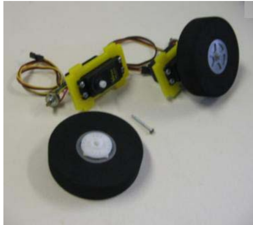
Figura 12. Rueda de neopreno y la adaptación al servo
