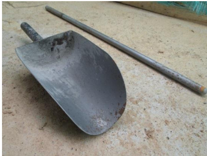
Figura 18. Cucharon y varilla compactadora
