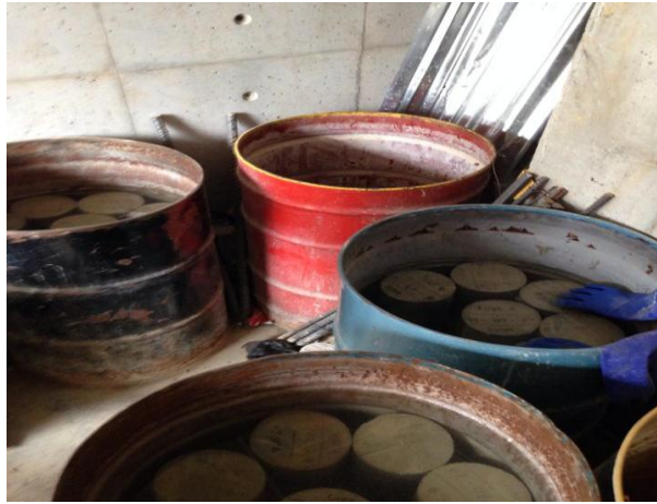
Figura 22. Cilindros en proceso de curado
