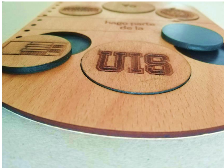
Fotografía 26. Detalle altura generada por el recubrimiento de lámina imantada
