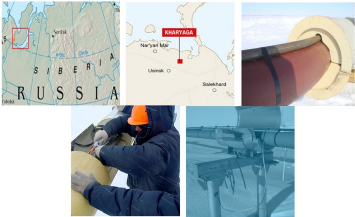
Figura 17. Calentamiento eléctrico en Campo Kharyaga, Siberia.
