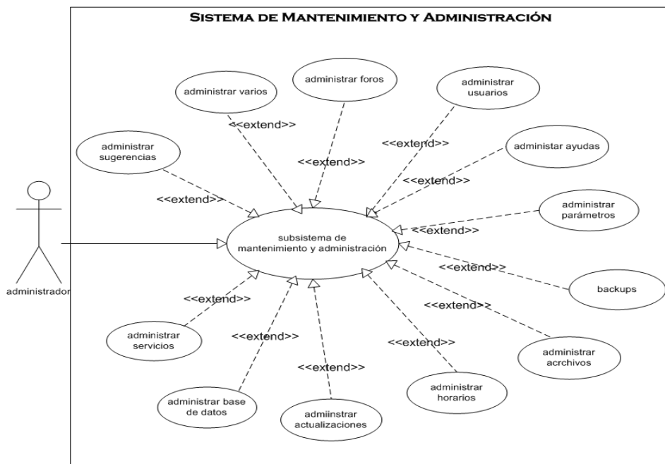
Figura 24. Diagrama de Casos de Uso: Subsistema de Mantenimiento y Administración.
