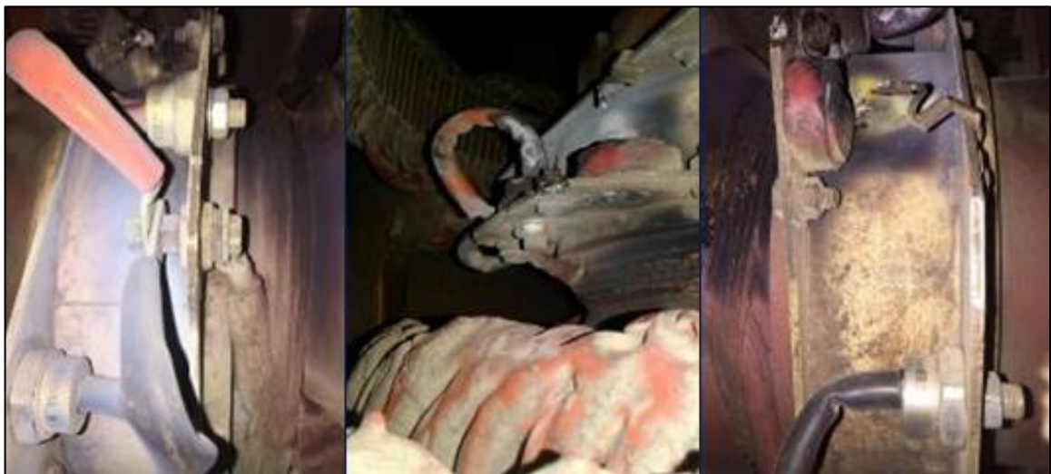
Figura 22. Diodos quemados (2 positivos, 1 negativo).
