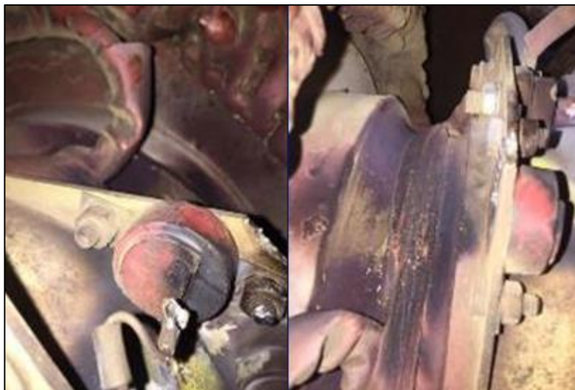
Figura 23. Varistor de platos de diodos quemados.
