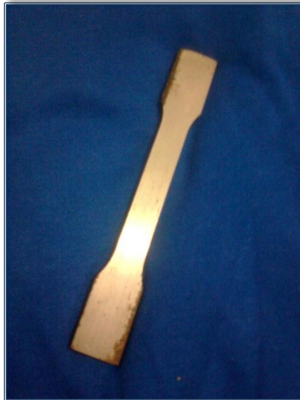
Figura 22. Fotografía de la probeta utilizada en el ensayo de tracción.
