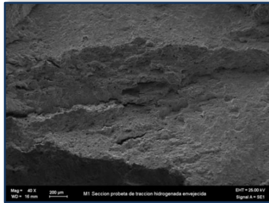
(c) Presencia de fisuras y microvacios
