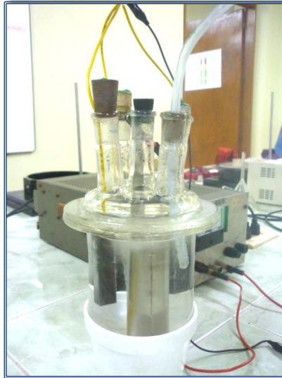
Figura 21. Montaje del ensayo de absorción de hidrógeno por polarización catódica
