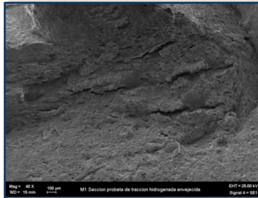
(c) Presencia de fisuras y microvacios
