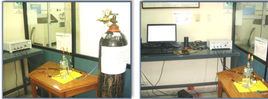
Figura 18. Montaje del ensayo de polarización potenciodinámica
