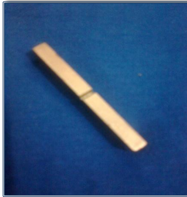
Figura 23. Fotografía de la probeta tipo Charpy sub estándar utilizada en el ensayo de impacto
