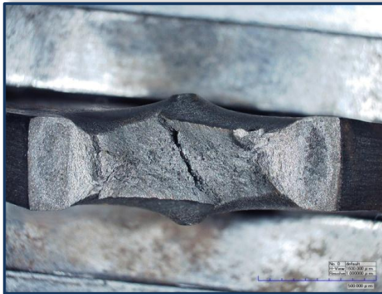
(a) Morfología de falla de la probeta de impacto
