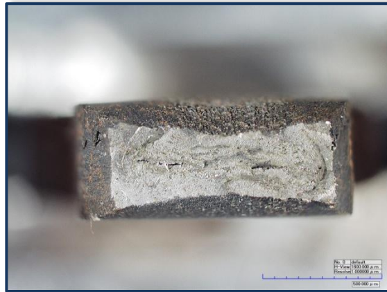
(b) morfología de falla de la probeta de tracción
