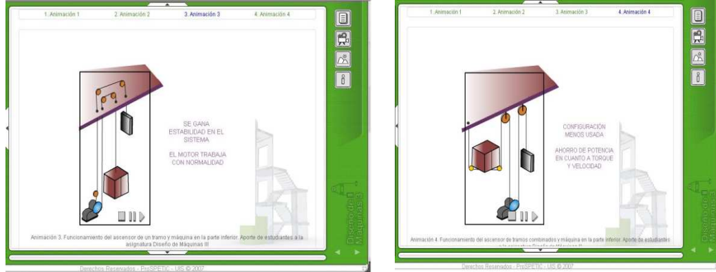
Figura 35. Animaciones 3 y 4 de disposiciones del cable de la cabina y contrapeso
