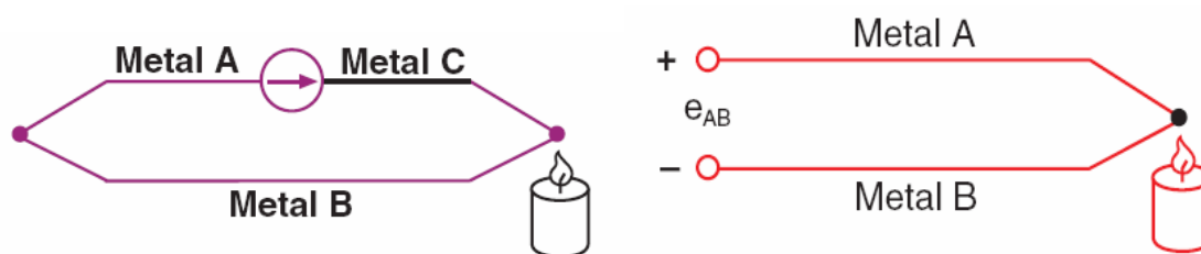
FIGURA 12. En la izquierda efecto Seebeck, a la derecha Voltaje de Seebeck. Fuente: Omega Engineering Inc.
