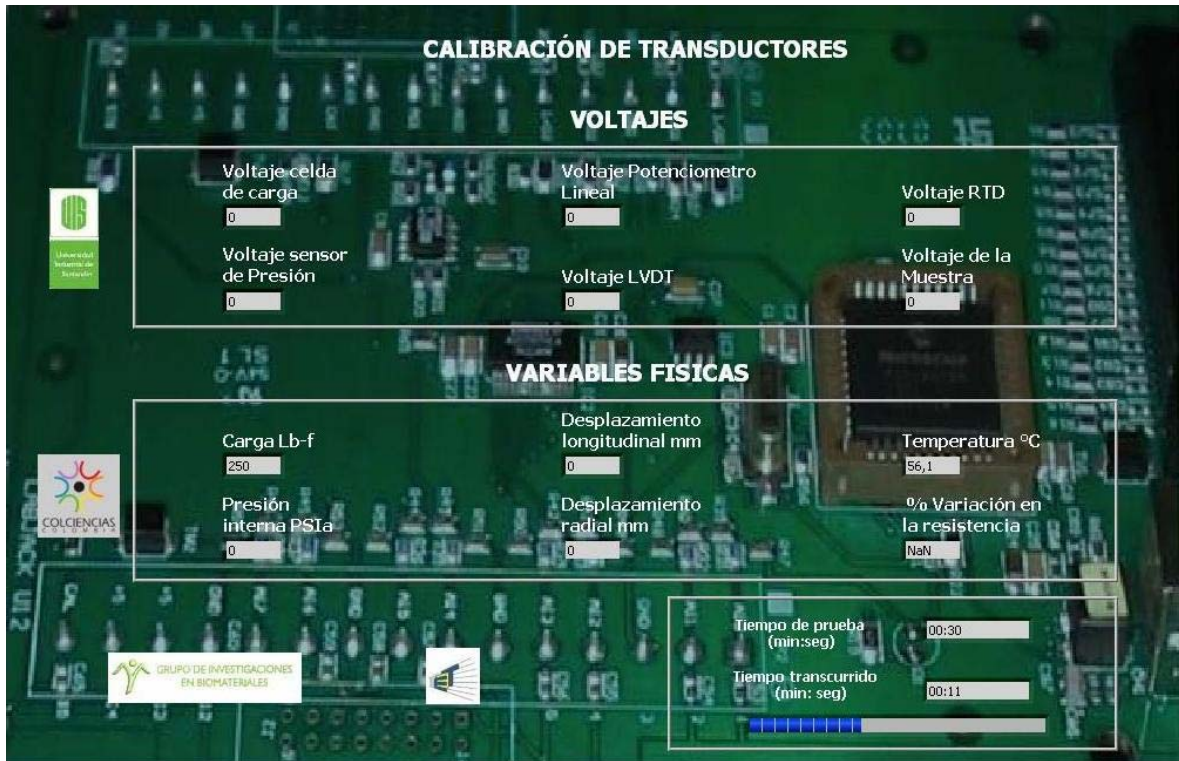
FIGURA 58. Panel Frontal del VI para la Calibración de Transductores. Fuente: El Autor.
