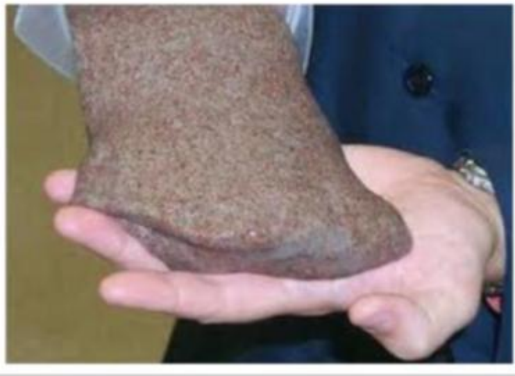
Figura 16. Fluido de fracturamiento mezclado con material propante
