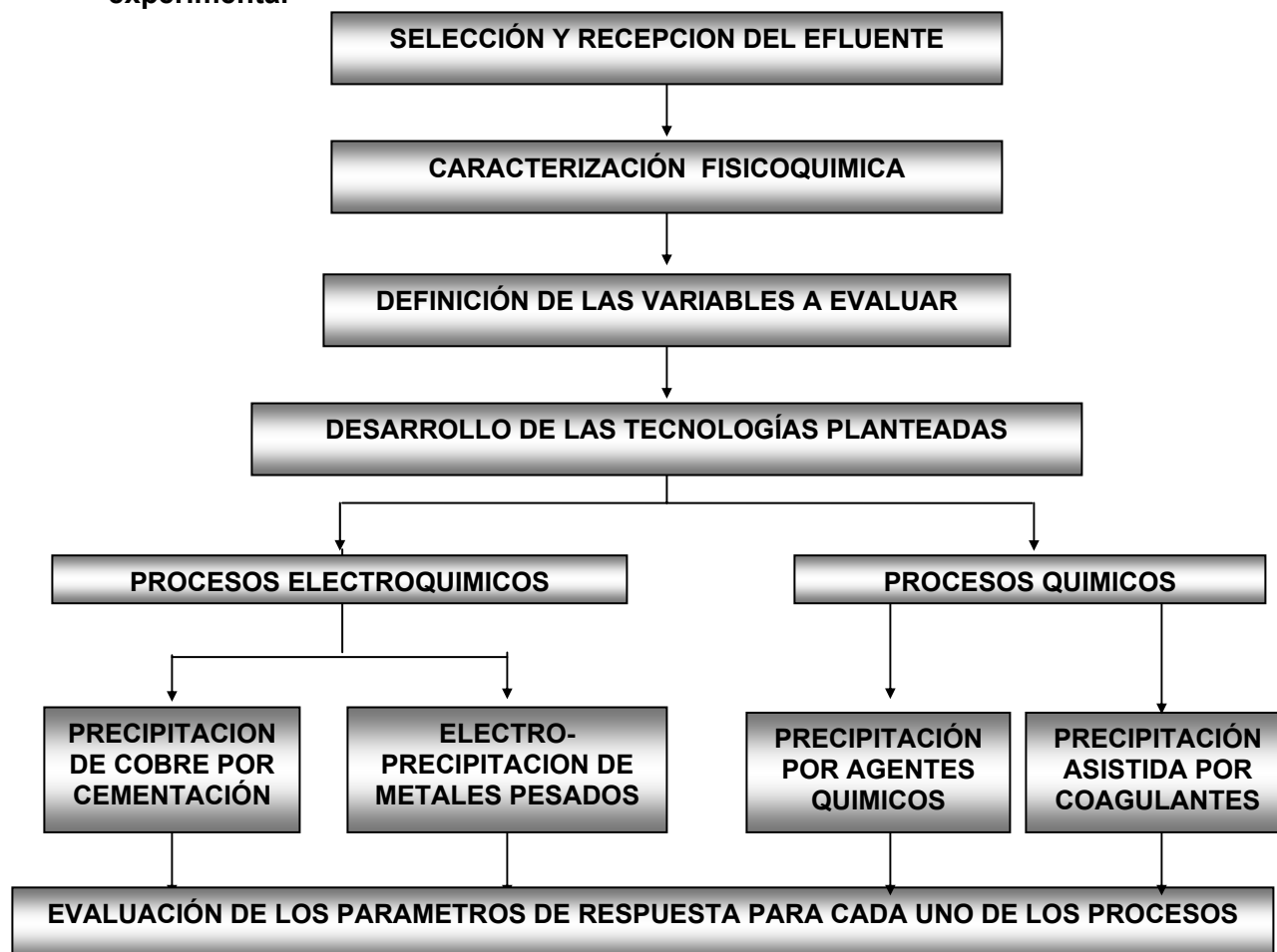
Figura 5. Diagrama de cada una de las etapas desarrolladas en el estudio experimental
