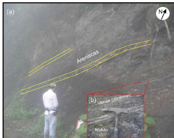
Figura 40. (a) Intercalación de shale con areniscas de grano fino. (b) Se detallan las venas y nódulos calcáreos, en la Formación Simití (?), vía Palmira hacia la Concentración de Desarrollo Rural “José A. Galán”. Estación 121.
