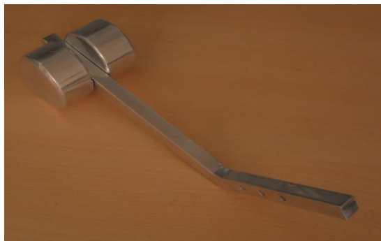
FIGURA 67. Soporte del contrapeso
