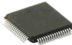
FIGURA 10. Microcontrolador MCF51QE128 Coldfire V1
