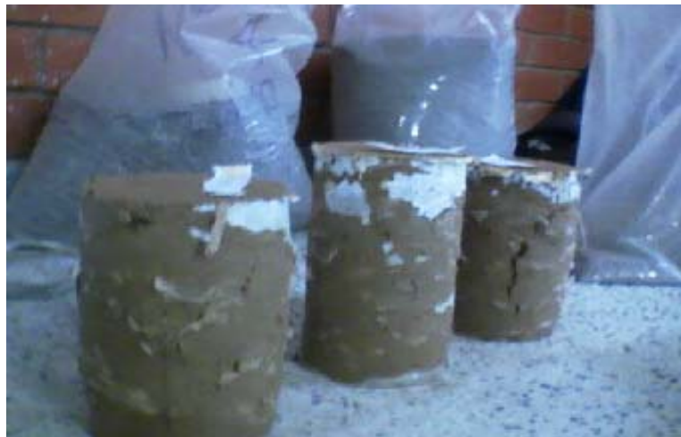
Figura 10. Probeta con polietileno de baja densidad fallada a compresión simple.
