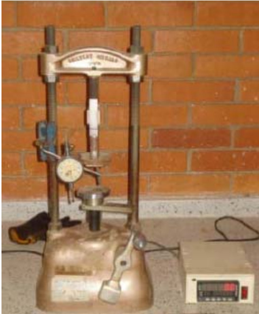
Figura 5. Ensayo compresión simple.
