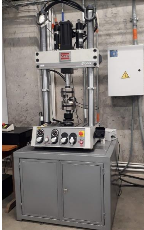
Figura 4 Máquina universal de ensayos MTS Bionix® Servohydraulic Test Systems Model 370.02.
