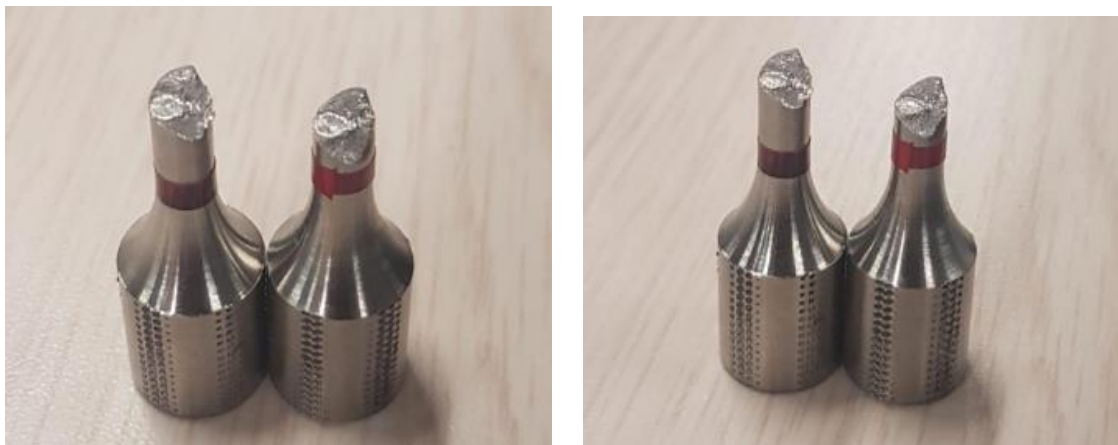
Figura 8 Probetas aleación de Titanio Ti6Al4V.
