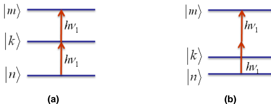
Figura 1. Esquema de las posibles transiciones electrónicas por la absorción de múltiples fotones
