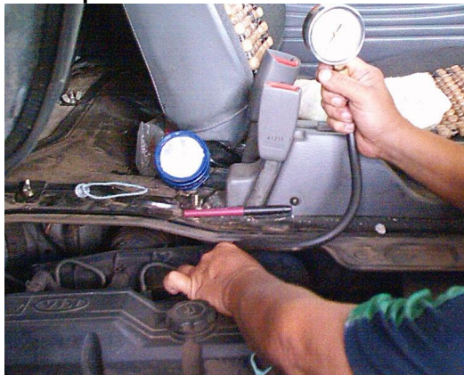
Figura 6 Prueba de compresión por medio de un manómetro.
