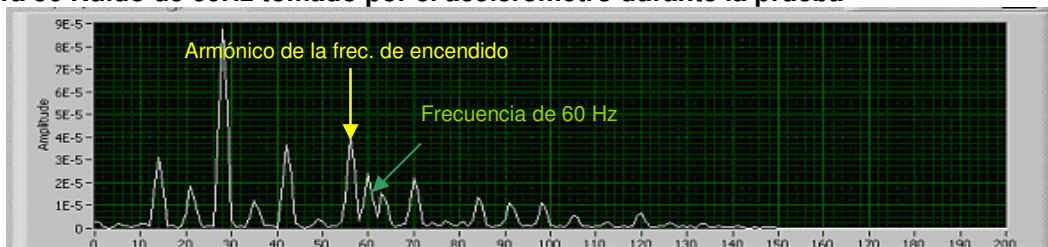
Figura 56 Ruido de 60Hz tomado por el acelerómetro durante la prueba
