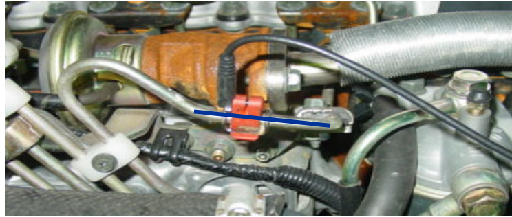
Figura 82 Colocación de la pinza piezoeléctrica en uno de los tubos de inyección de combustible para referencia
