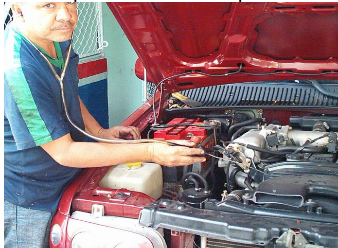
Figura 8 Diagnóstico de fallas por medio de un estetoscopio.
