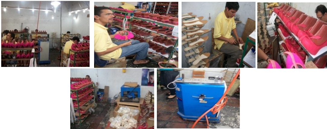
Figura 11. Proceso de Soladura, montaje y terminado
