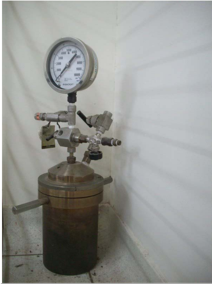
Figura 5. Reactor de alta presión y temperatura
