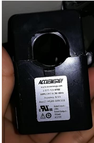
Figura 34. T.C usado para sensar todo el sistema FV con acometida principal en el piso 4.
