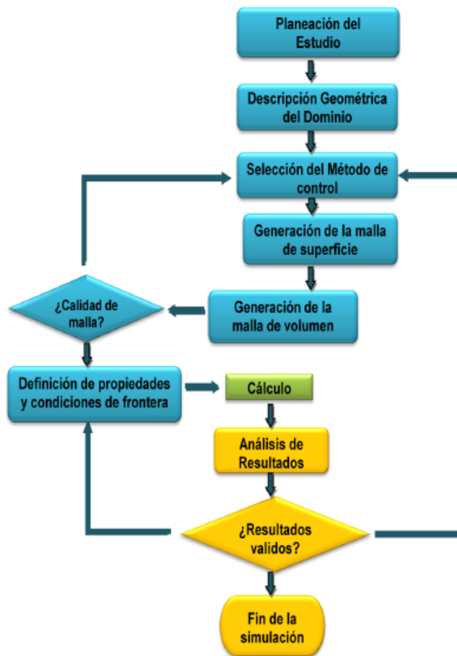
Ilustración 4. Metodología general CFX. Tomado de: Modelamiento de flujo compresible por el método de los volúmenes finitos en gasoductos, 2010.
