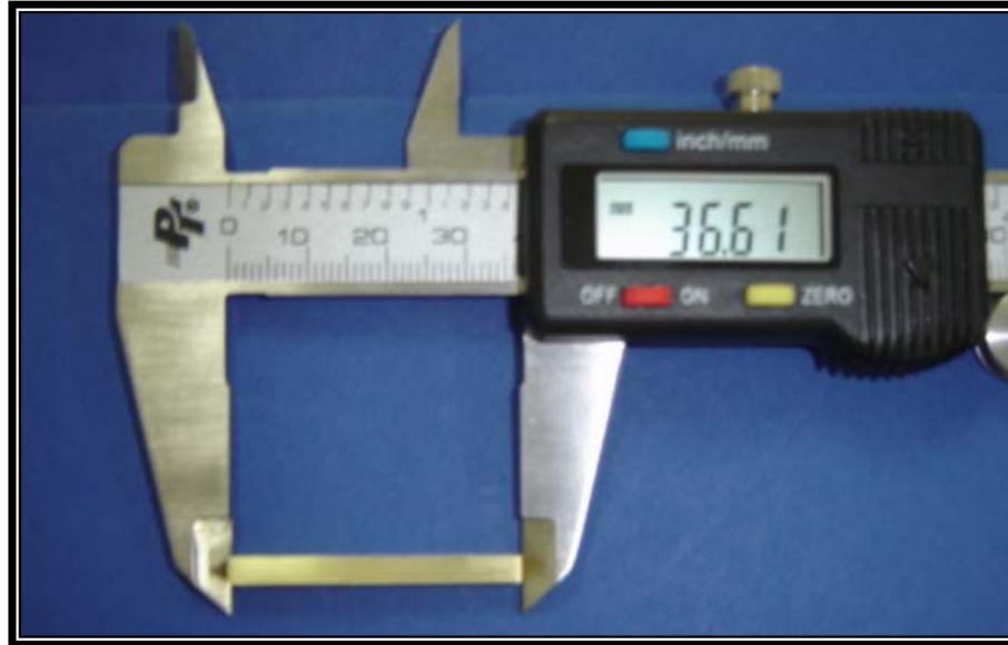
Figura 18: Fotografía de la probeta para ensayo de flexión
