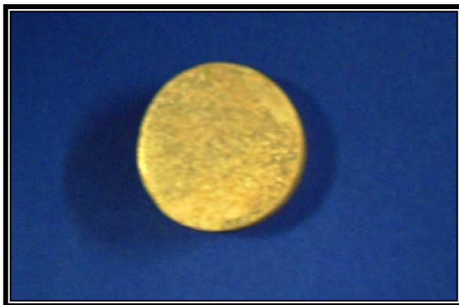
Figura 11. Probeta pulida y atacada para análisis metalográfico
