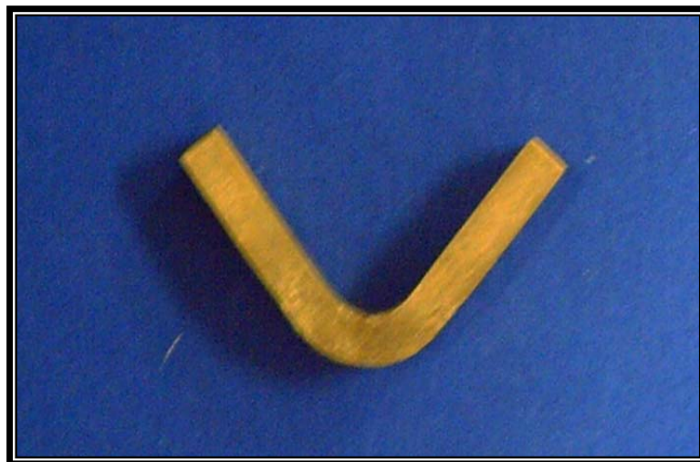
Figura 32. Probeta F2 deformada en flexión
